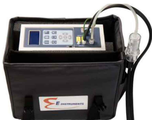
+ Máy đo hàm lượng khí GAS ANALYSERS/E INSTRUMENT, số hiệu: 22329, phạm vi đo (CO 2 0-50)%, O 2 (0-25)%, CO (0-8000)ppm, NO (0-5000)ppm, NO 2 (0-1000)ppm, SO 2 (0-5000)ppm hiệu chuẩn tại Trung tâm Kỹ thuật tiêu chuẩn Đo lường chất lượng 3.
