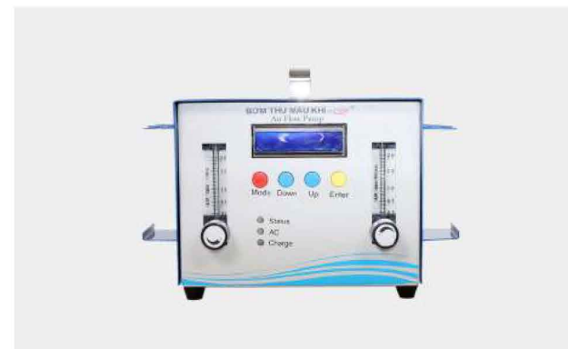
+ Thiết bị thu mẫu khí C2P, số hiệu: 838-043, phạm vi đo (0,1-2)L/phút hiệu chuẩn tại Trung tâm Quan trắc môi trường - Tổng cục Môi trường.
