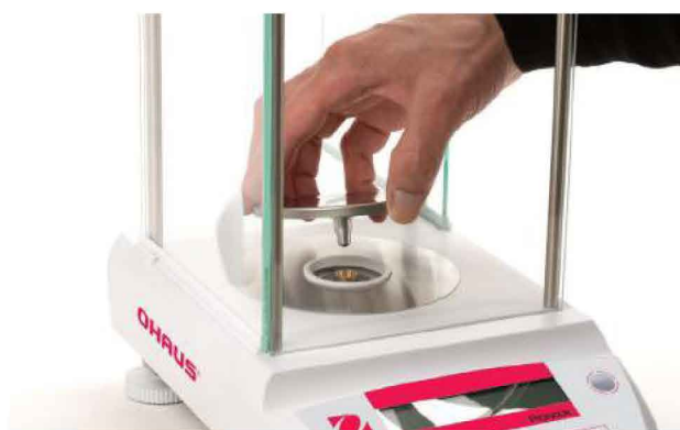
+ Cân điện tử Ohaus/PA214, số hiệu: B619449979, độ chia nhỏ nhất 0,1mg hiệu chuẩn tại Trung tâm Kỹ thuật tiêu chuẩn Đo lường chất lượng 3.
